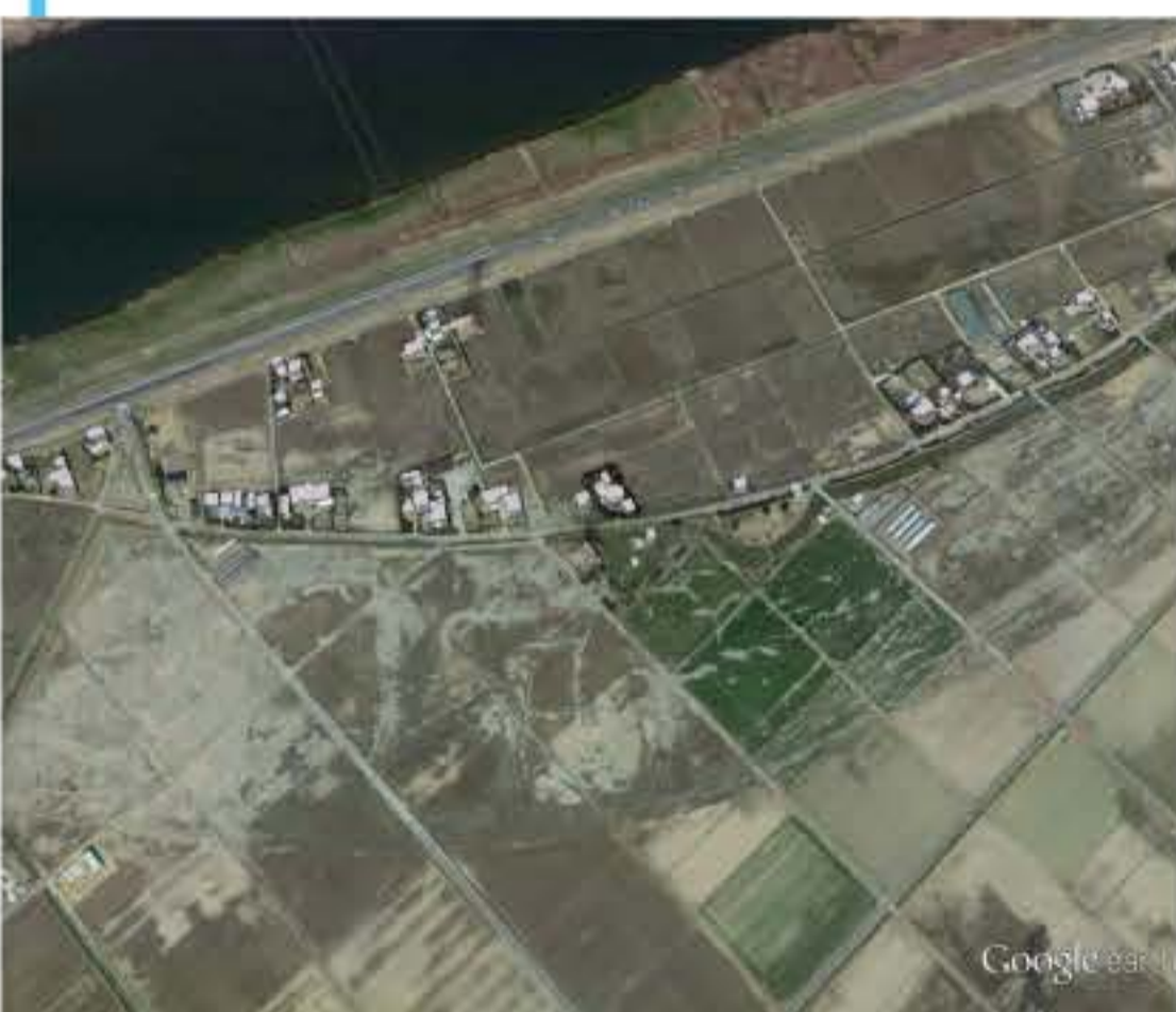
上空から見た噴砂 (2011年東北地方太平洋沖地震 千葉県神崎町) Google Earth (2011年3月29日撮影)より
