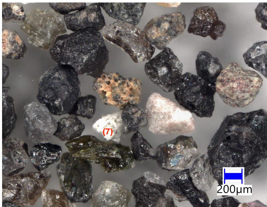
図1. 2024年7月29日16時46分桜島火山灰のデジタル顕微鏡写真(粒径 >250µm). (1)黒色不透明で光沢のない粒子, (2)灰色不透明で光沢のない粒子, (3)黒色で光沢があり発泡痕のある粒子, (4)赤色化した粒子, (5)淡色～褐色半透明で発泡痕のある粒子, (6)結晶片, (7)変質粒子。
