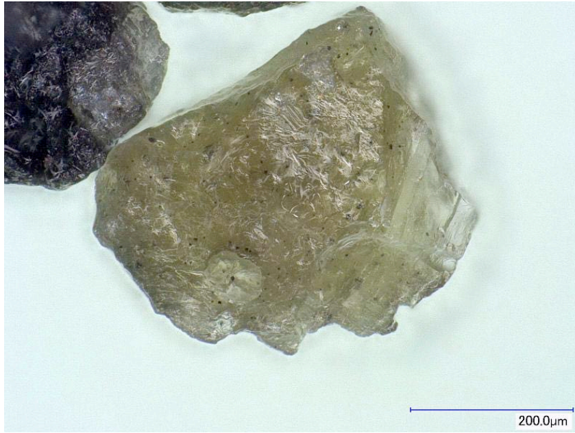
図 3. 本質物と考えられる、緻密でブロック状の外形を示す淡褐色・透明でガラス光沢をもつ粒子 (gd).
