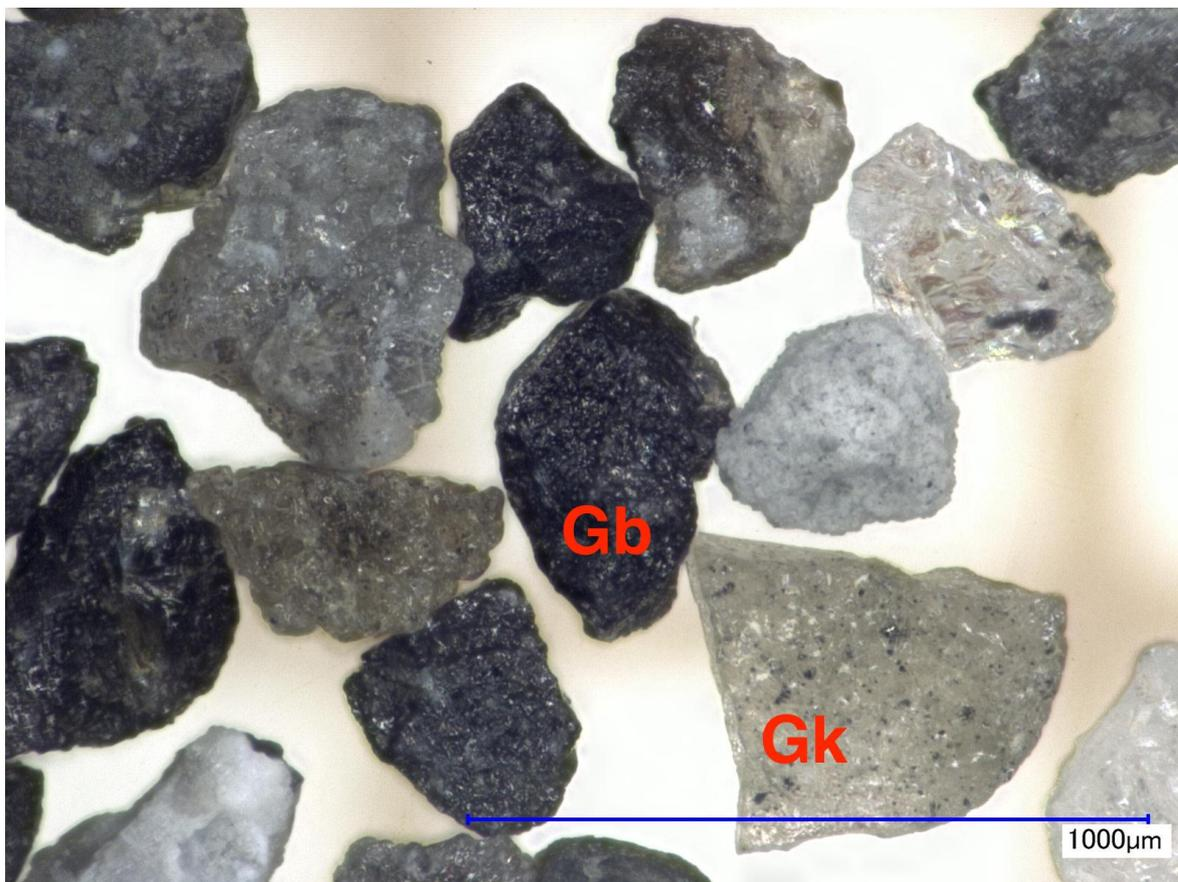
写真3 : 同火山灰. Gk : 透明感があり微結晶を含むガラス光沢岩片. Gb : 表面が気泡内壁様の形状を示す粒子. これらガラス光沢あるいはガラス質片は, 最近地下深部から供給されたマグマ物質の破片の可能性がある.
