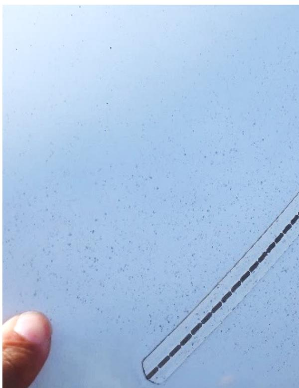
写真3 飛行機の機体についた火山灰。機頭に付着した火山灰。13:20 頃硫黄島で給油中に撮影。
