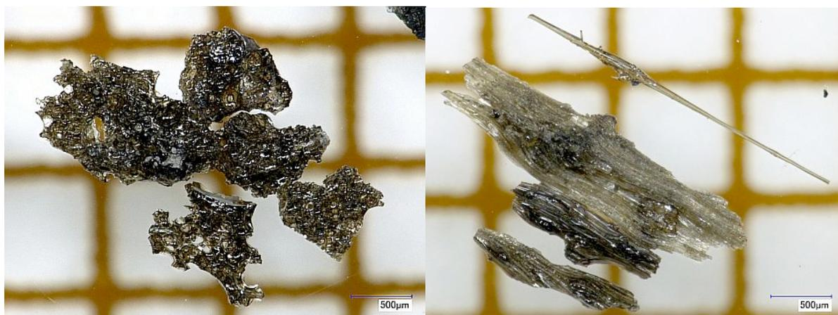
図 3 左：等方的に発泡した淡褐色ガラス質粒子。右：引き伸ばされた淡褐色ガラス質粒子。いずれも 2015 年 1 月 28 日の噴出物中の粒子。
