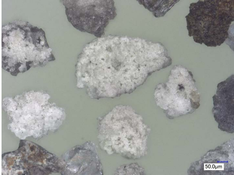
図 3. 2019 年 8 月 7 日の浅間火山噴出物に含まれる灰白色多孔質粒子（水洗後；125～250 μm）.
