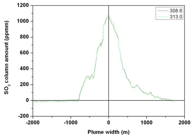
308.6nm、313.0nmの各波長を用い計測したSO<sub>2</sub>放出量の時間変化。
