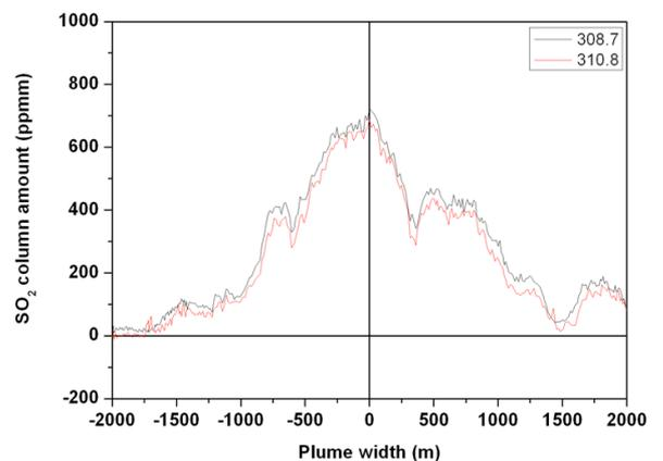
308.7nm、310.8nmの各波長を用い計測した、SO<sub>2</sub>放出量の時間変化。313.1nmはサチュレーションにより、使用できなかった。
