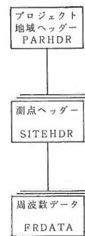
第 1 図 データ構造図。 Fig. 1 Logical data structure of the MT data base.
