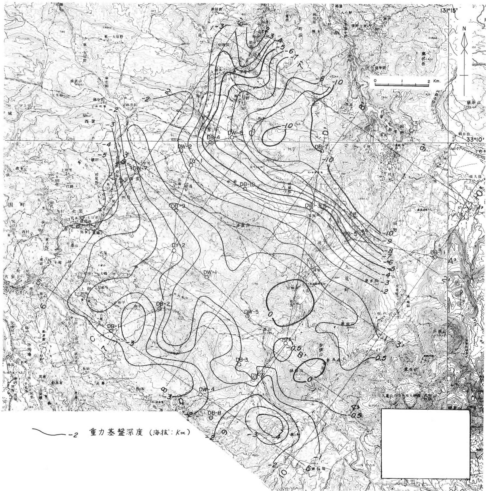
第4-1図 重力基盤深度図(通産省, 1983c) 実際の坑井の基盤深度で補正している基盤岩の浅い部分では実際とよく一致しているが, 水平方向の密度勾配補正をしていないので低重力異常帯を過大評価している。「この地図は国土地理院発行の5万分の1(森)(宮原)(別府)(久住)を使用したものである」
