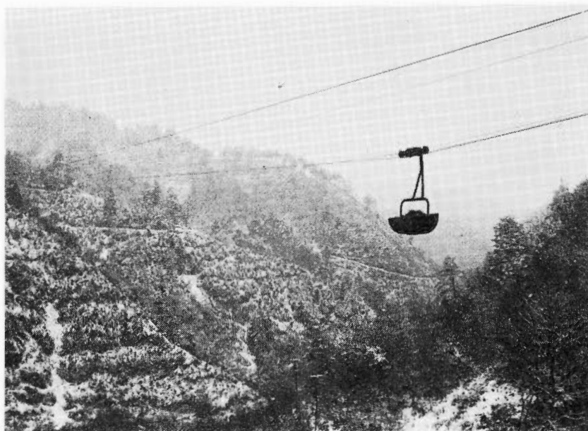
2. 清久鉱山西部鉱床（蘆刈鍾）用の索道 1959年2月 Cable cage for Mo-ore from the western parts of the Seikyu mine (February, 1959).
