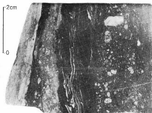
2. 角礫鉱脈③, 安山岩物質が(とくに左半分)に多量に含まれる (同上, 1, 2ともに右側が見かけの下位) Brecciated ore with much andesitic material at the Seikyu-Minamiko mine.
