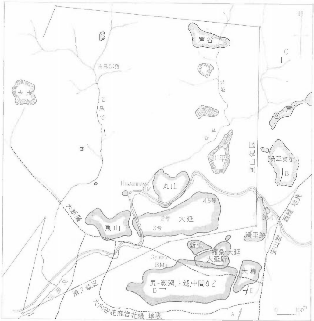
第 57 図 清久・東山鉱山諸鉱脈の平面投影 Plan of molybdenite veins at the Seikyū and Higashiyama mines.
