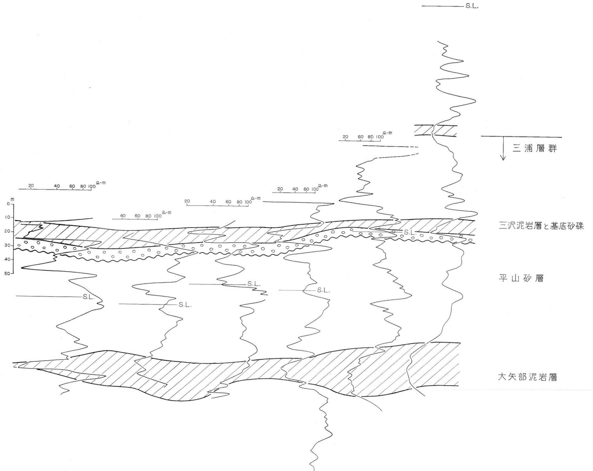
第3図 多摩町・立川・国立・府中・武蔵野の各所の電気検層曲線による三浦層群の対比
