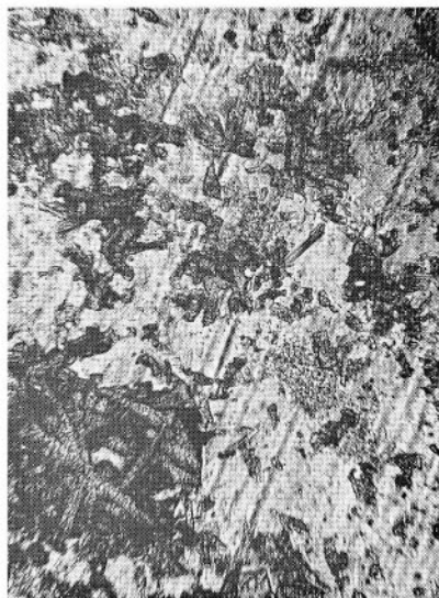
図版 10 電気石ホルンフェルス 桂岡鉄山第1 鉱床付近 ×30
