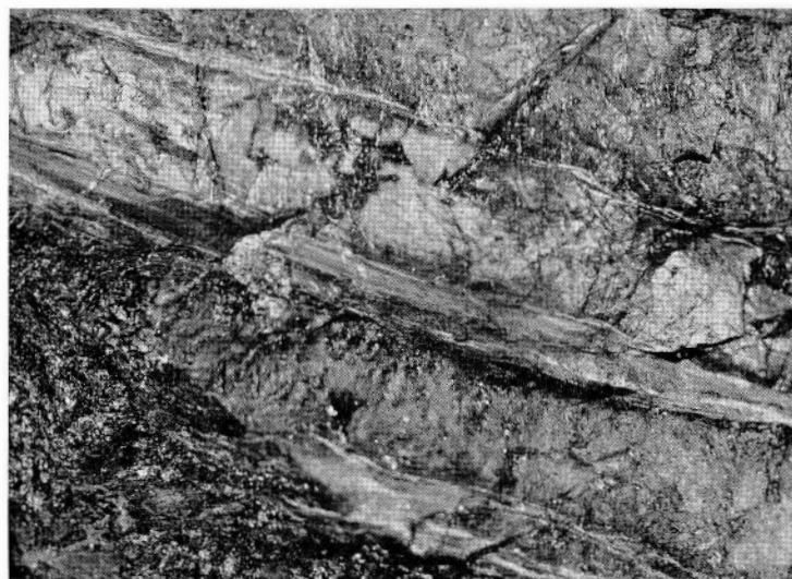
図版 6 石灰質珪岩中に発達する柘榴石スカルン 桂岡鉄山旭坑産 ×1
