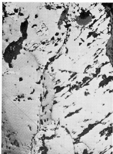
図版 25 磁硫鉄鉱散点鉱 梶溝鉱山産 反射×80 白色部：磁硫鉄鉱 灰色部：黄銅鉱
