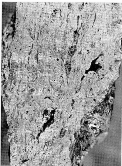
図版 39 褐鉄鉱と鉄明礬石の縞状鉄 宇登呂鉱山産 ×1 たて縞の暗色部が褐鉄鉱、灰色部が鉄明礬石 暗色部 Fe 51.05%
