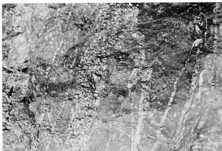
図版 5 磁鉄鉱石中の硫化鉄鉱脈 桂岡鉄山旭坑産 ×1
