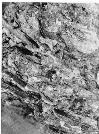
図版 37 ささの基を交代した褐鉄鉱鉄石 宇登呂鉱山産 ×1
