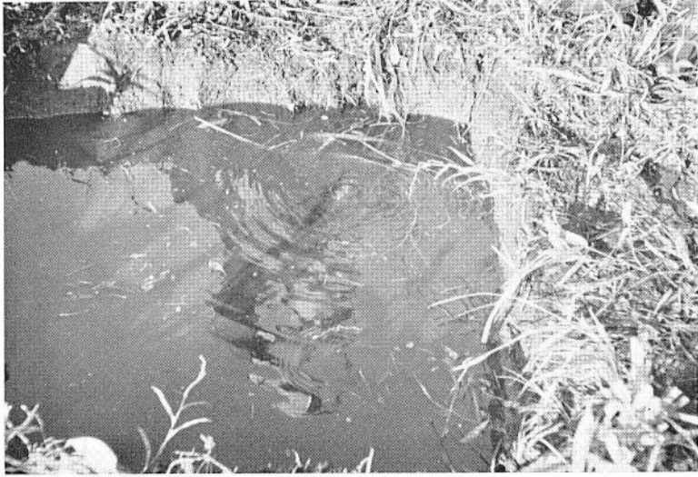
図版 11 泥炭地の遊離ガス。泥炭地に四角い穴を掘つて地下水を溜め、そのなかへスパイラルで孔を掘ると、数分間遊離ガスが自噴することがある。
