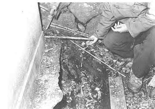
4. 土台の移動から求められる断層の変位量と運動のようす. ペンの立ててある面に, 土台の移動した跡を示す条線が記されている (Loc. 28) Measurement of the horizontal slip along the fracture at Loc. 28.
