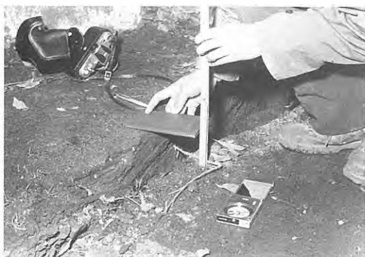
3. 断層の垂直変位量を測定しているところ (Loc. 28) Measurement of the vertical displacement of the fracture at Loc. 28.
