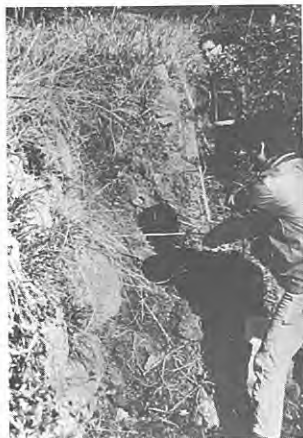
4. Plate 5-3 と同様、石垣の右横ずれとその変位量測定作業 (Loc. 27) Same as Plate 5-3
