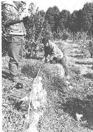
3. ミカン園内の石垣に生じた右横ずれ断層変位とその変位量測定作業 (Loc. 27)
