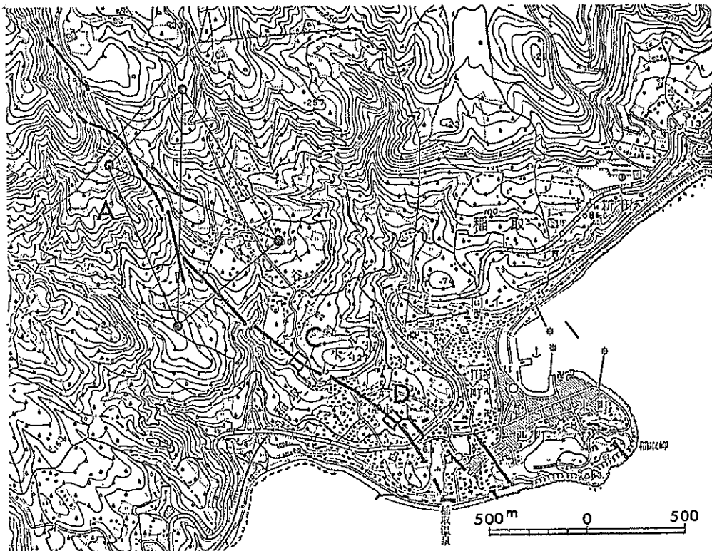
第1図 稲取・大峰山断層（太実線）と観測点位置（G, D）。Aは光波測長用の観測網（橋本ほか，1979を参照） 「この地図は、国土地理院発行の2万5千分の1地形図（稲取）を使用したものである」
