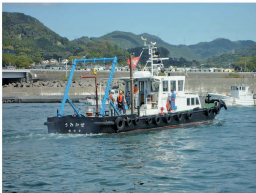
写真 1 海底重力調査船 Photo 1 Survey vessel, Umikaze, 19 ton, 17 m (Yamaguchi Marine Co., Ltd.).
