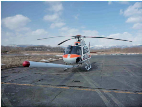
第 2 図 空中磁気探査調査ヘリコプター(中日本航空(株)所有(大熊・中塚, 2013) AS350B3 型機。機体下部にスティンガーを固定し、その内部に Cs 磁力計センサーおよびプリアンプ、フラックゲート型磁力計センサーを収納する。撮影場所: 北海道白老町白老滑空場(以下同様)。 Fig. 2 Survey helicopter employed for the aeromagnetic survey over the Coastal Zone of the Suruga Bay area (Okuma and Nakatsuka, 2013). Eurocopter AS350B3 owned by Nakanihon Air Service Co., Ltd. A Cs magnetometer sensor and its pre-amplifier, and a fluxgate sensor were installed in the stinger attached to the helicopter. The photo was taken at the Shiraoi Gliderport, Shiraoi, Hokkaido and so forth.
