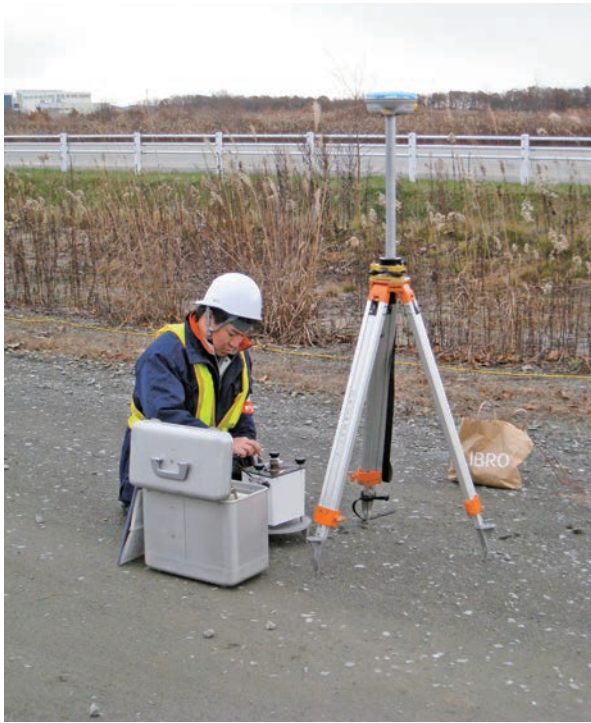
写真 1 本調査における重力測定風景（測線 2, csd0375a）。
