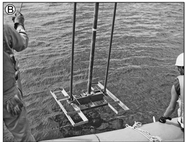
第 2 図 A : 柱状試料の採取に用いたバイプロコアラ。 B : バイプロコアラの先端部.
