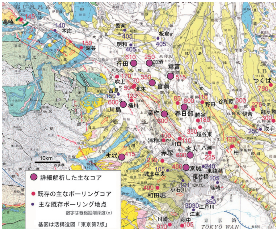
第1図 主なボーリング地点位置図。基図は杉山ほか（1997）による。広域テフラと考えられるガラス質の火山灰層は、火山ガラスの屈折率や ICP 発光分析あるいは EDX による化学分析から、房総半島等に分布するテフラとの対比を行って、同定した。
