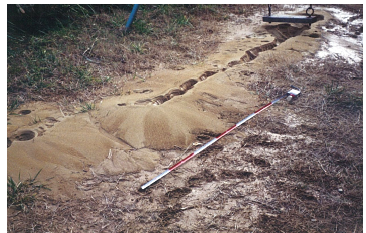
地震直後に見られるさまざまな地変。上は兵庫県南部地震における神戸港の地盤被害状況。下は噴砂現象。このような地質学的諸現象をすばやく正確に記録することが必要です。
