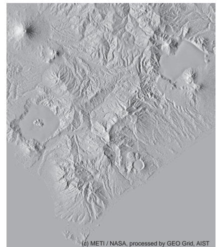
図2 ASTER画像から生成した北海道室蘭市周辺の標高データ(DEM)
