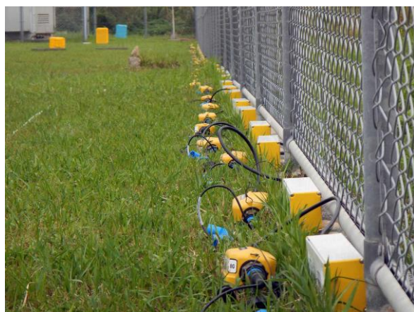
写真 4. オフライン方式探査システムによる浅層反射法の機材展開の様子。
