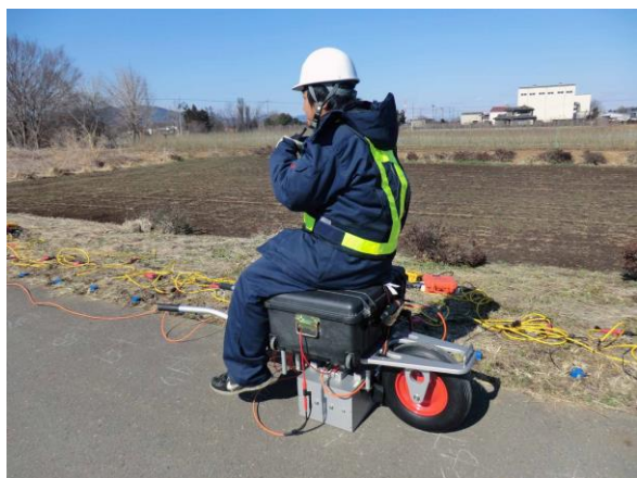
写真 1. 可搬型バイブレーター震源による発震の様子。
