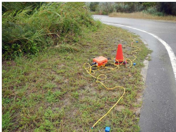
写真 3. テレメトリ方式探査システムの機材展開の様子。
