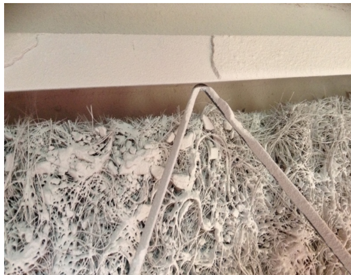
図 39 隙間部分の拡大写真(圧力損失 500Pa)
