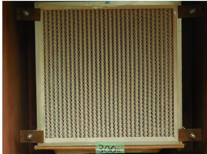
図 41 耐圧試験時のフィルタ状態写真(圧力損失 300Pa)
