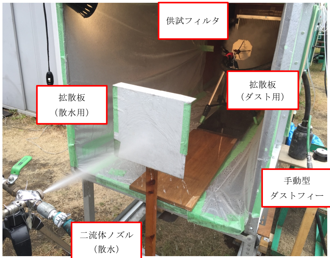
図 36 散水状態試験時の耐圧試験ダクト内部の状況
