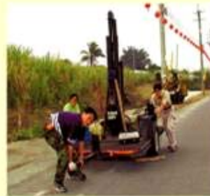
圖四 EWG-III 彈簧式重錘震源，主要應用於活動斷層調查。
