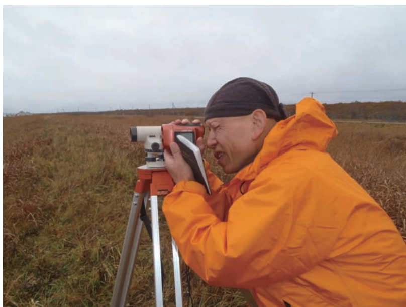
写真2 レベルとレーザー距離計を併用した測量風景。
