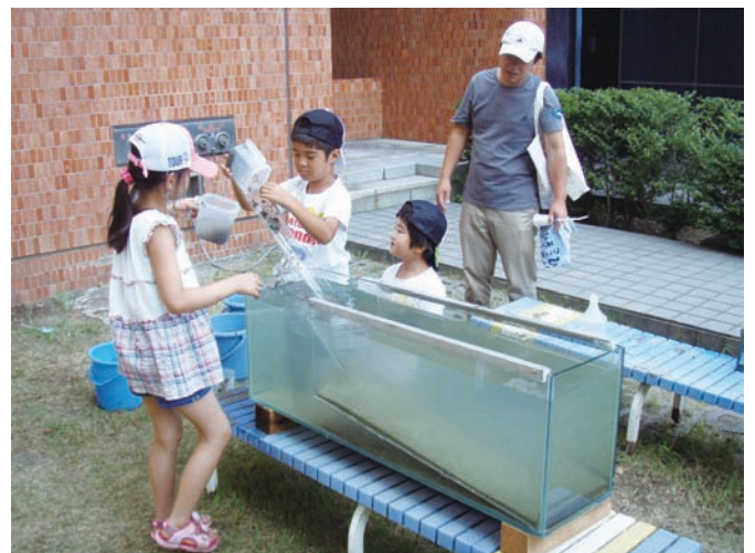
写真1 大型水槽での乱泥流発生実験。今年度は、実験後、水槽底に溜まったタービダイトを引き上げて直接観察することができるように改善した。
