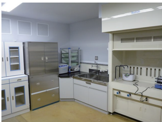
第2図 ルミネッセンス年代測定試料準備室. 試料処理作業は赤色灯下で行う. 左から, 試料保管庫, 薬品庫, 遠心分離器, 乾燥器, 流し台, ドラフト.
