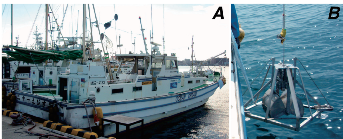
第1図 調査に使用した船舶 (A) と採泥器 (B) Fig.1 Ship (A) and grab sampler (B) used for the survey.
