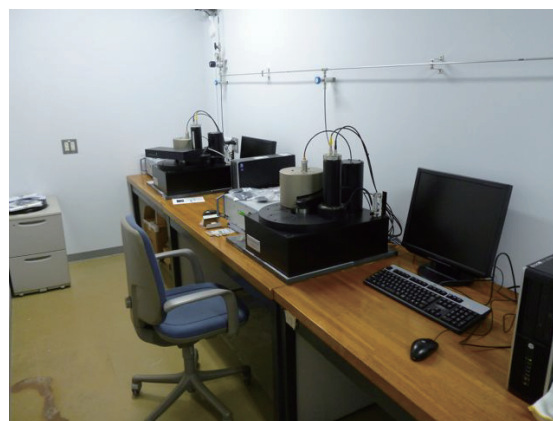
第1図 ルミネッセンス実験室。試料装填は赤色灯下で行う。
