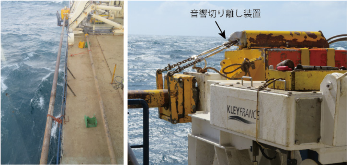
写真6 舷側に沿って投入準備完了のピストンコアラー CALYPSO (左) と重錘の音響切り離し装置 (右)
