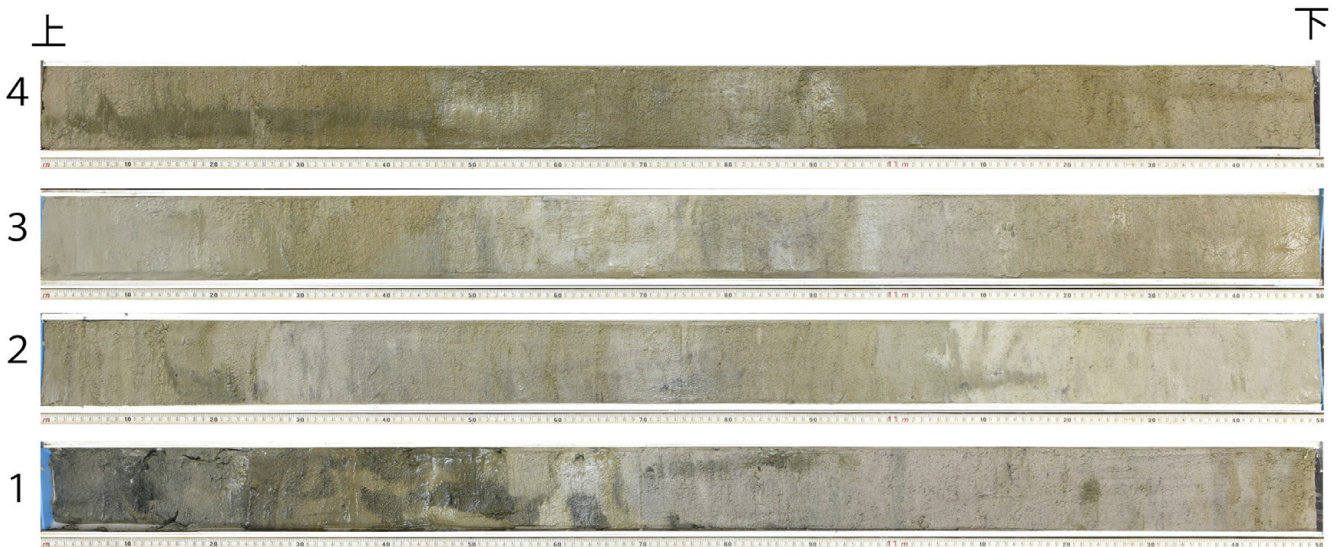
写真9 MD218 航海で採取されたピストンコア上部の様子。1～4の順に深度が深くなる。再表層の50 cm 程度までに若干の乱れはあるが,以下では認められない。1セクションの長さは1.5 m。
