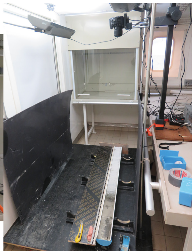
写真14 コアラボに設置されたコア写真撮影装置
