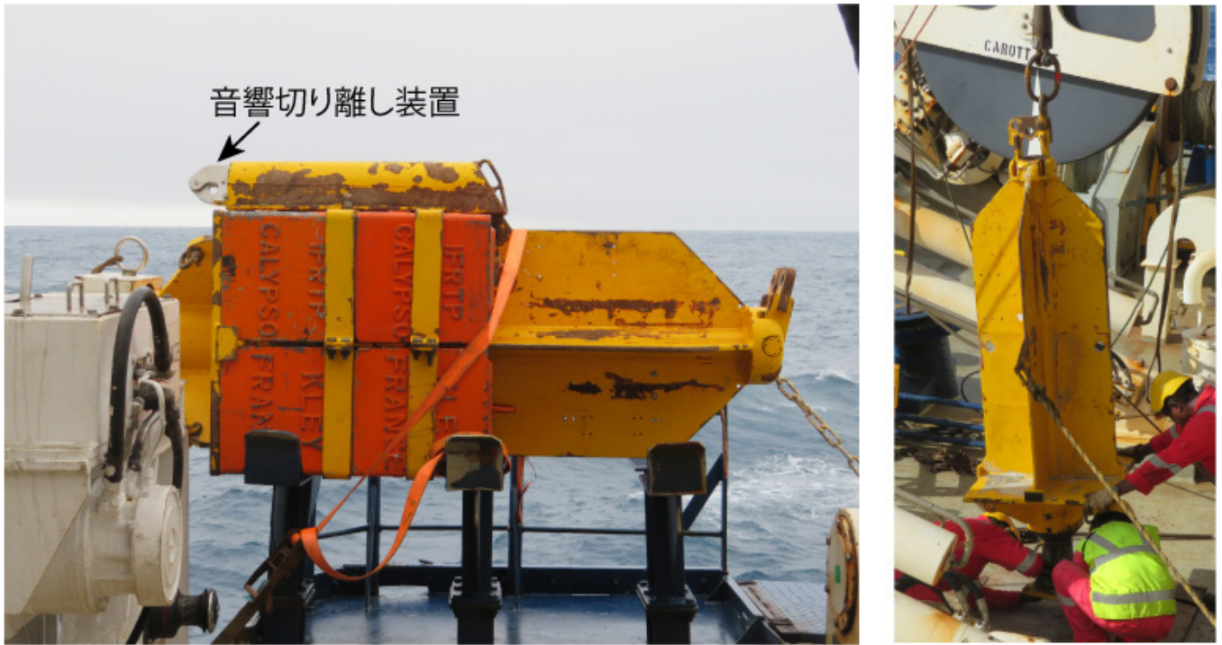
写真4 コアリング用の重錘（ヘッド：左）. 黄色のフレーム（右）に 500 kg の直方体の錘を 8 つ付加させている.
