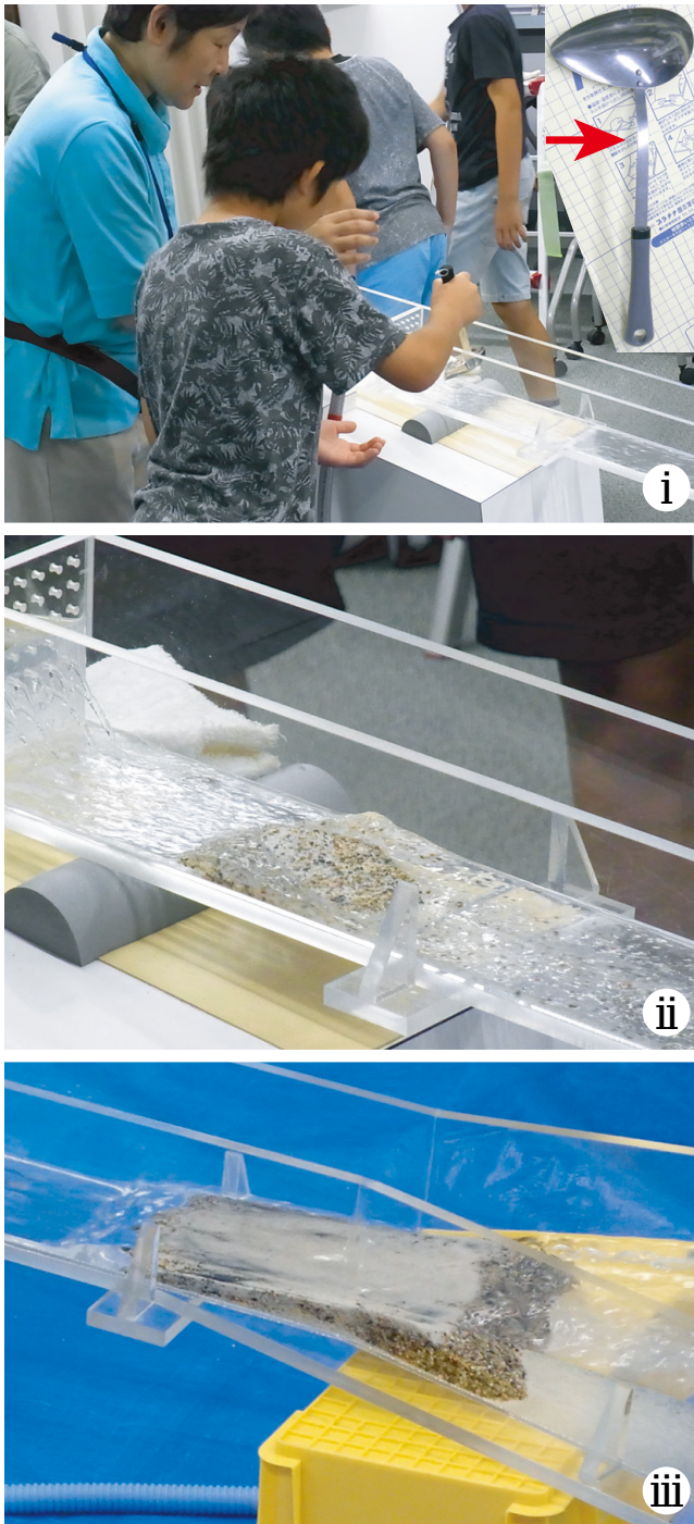
第5図 実験の様子(続き). i) 水路への“砂”の投入風景. 実際に児童に投入してもらうむ児童もあるがガラスによりけり. インセットは投入に使用する“おたま”で図のように卵型のほうがよい. 円形の“おたま”は使いにくい. ここでは柄を曲げて児童が使いやすいようにしている(矢印). ii) 投入された“砂”が流れる様子. iii) 流れた“砂”が河口で堆積し三角州が発達する様子.
