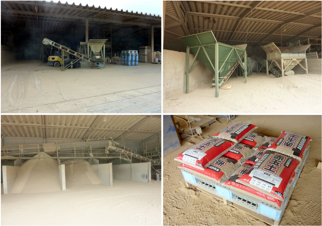
写真5 乾燥された原土は工場へ。(左上)工場は鉄骨づくりに簡単なつくりで、ホッパーやベルトコンベアが並んでいます、(右上)ホッパーからベルトコンベアで篩へと繋がる赤玉土の篩い分けライン、(左下)回転篩が主役の鹿沼土の篩い分けライン、(右下)製品によっては袋詰めされパレットの上に並べられます。
