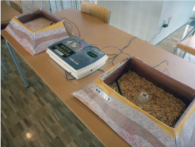
写真1 前(参加者側)から見た地熱ゲーム機。2つの地熱地域モデルが1台の探査装置に繋がっています。1人でも2人での対戦モードでも遊ぶことができます。枕の芯に使われるポリエチレンパイプや、すだれを細かく切ったチップでモデルの底の地熱ポイントを隠しています。
