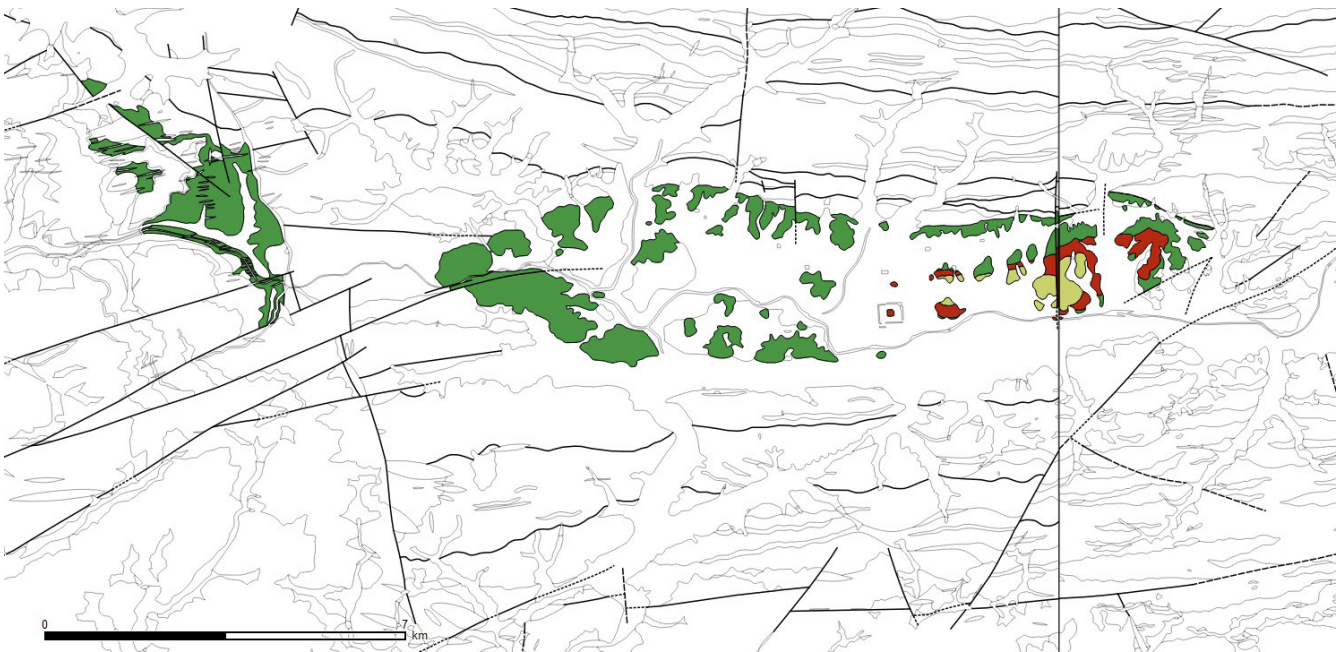
第3図 1/5万地質図「篠山」（栗本ほか、1993）と「園部」（井本ほか、1991）の篠山層群のデータを抜粋して接合した地質図。この図ではあえて図郭線（右側の縦の直線）を残していますが、GISでは図郭線を非表示にすることも簡単です。ベクトルデータは上述の「地質図類データダウンロード(*5)」から入手できます。
