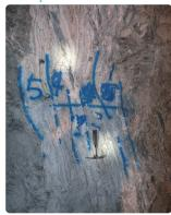
鹿児島県伊佐市に位置する菱刈鉱山は、1985年から現在に至るまで高品位金鉱石を安定して出鉱しており、世界的にも有名な金銀鉱山である.鉱石である含金銀石英脈は、第四紀の広域的な引張応力場によって生じたほぼ垂直な割れ目の中に熱水が浸入し、それが冷却して石英や金銀鉱物が晶出することによって形成された.温泉水は現在も湧き出ており、地元の湯之尾温泉に供給されて有効利用されている.写真は菱刈鉱山の山田鉱床の友泉 6 脈 (海抜 110m)であり、乳白色ないし灰色の石英による縞状構造が見える.この石英脈の母岩は更新世の菱刈下部安山岩である.
