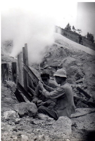
第2図 噴気中のガス成分( H_2O , H_2S , CO_2 , O_2 )の現地分析。
