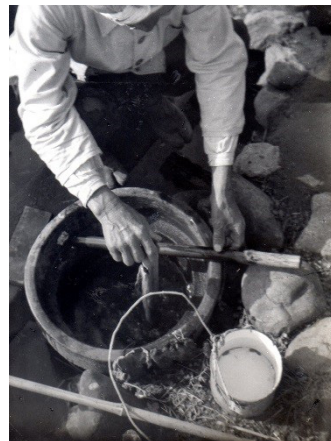
第6図 自噴井調査状況。 (掘り抜き井戸がどの高さまで自噴するかを竹筒を継ぎ足して測定)
