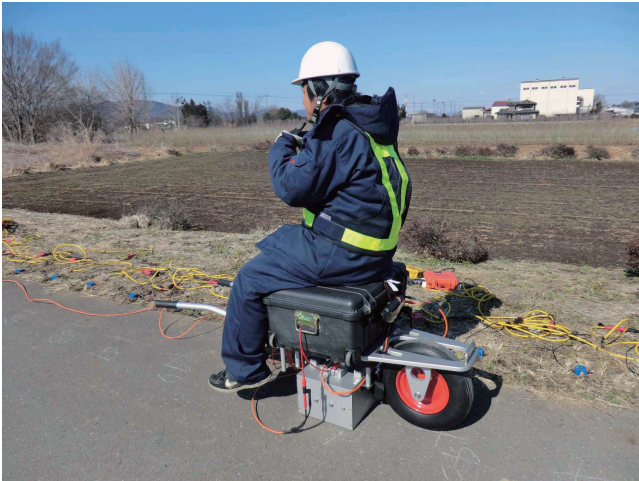
写真2 可搬型バイブレーター震源を用いたS波スイープ発震作業の様子。作業員はバッテリーユニットの上ののりようを加えている。
