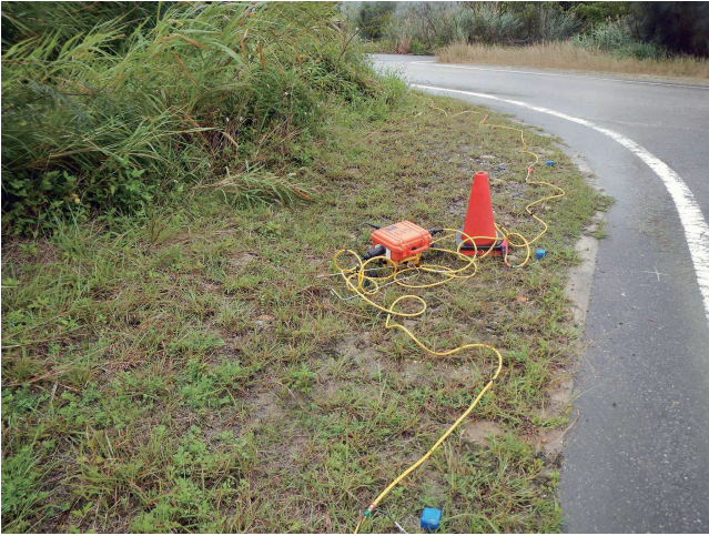
写真3 分散型地震探査システムの展開の様子。いくつか見える青いものが受振器であり、受振器12個分の波形記録をオレンジ色の収録ユニットでA/D変換し、デジタル化された信号をLANで送信する。
