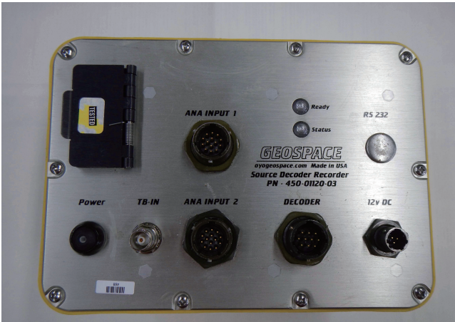
写真6 SDRと呼ばれるトリガ時刻を記録する装置。AUX入力も備えており、バイブレーター震源を用いた場合にはスイープ信号を記録することが可能である。
