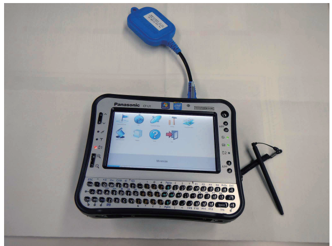
写真5 Line Viewerと呼ばれるpodの動作確認装置。上に飛び出ている青いものは本体とUSB接続されており、動作確認用のアプリケーションソフトウェアのライセンスを確認するドングルとBluetoothのアンテナを兼ねている。
