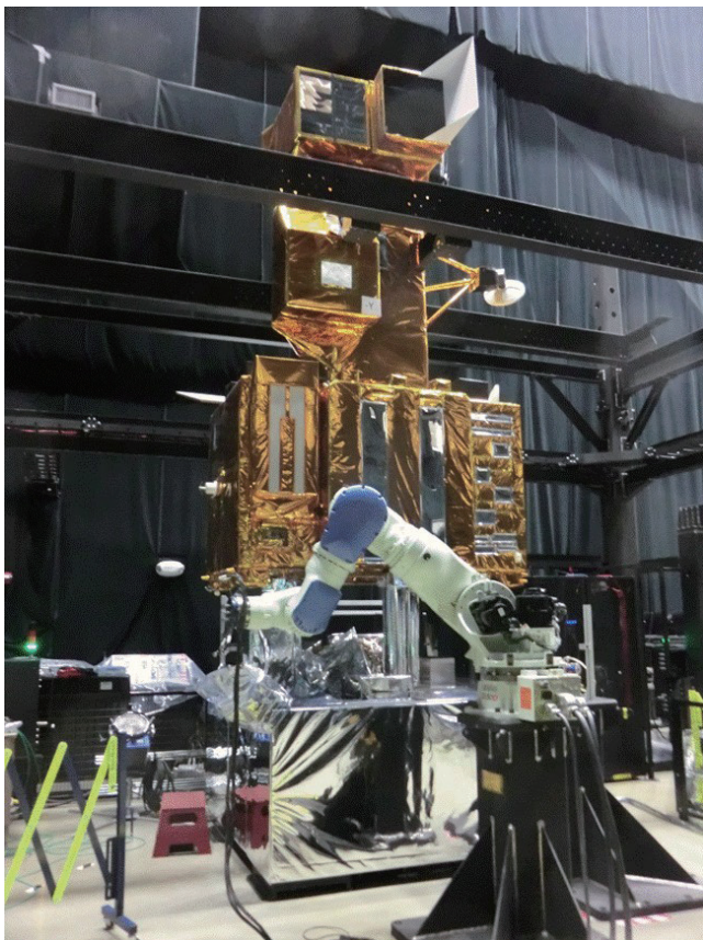
写真1 実験用のランドサット7号の模型(高さ約4m)とロボットアーム
