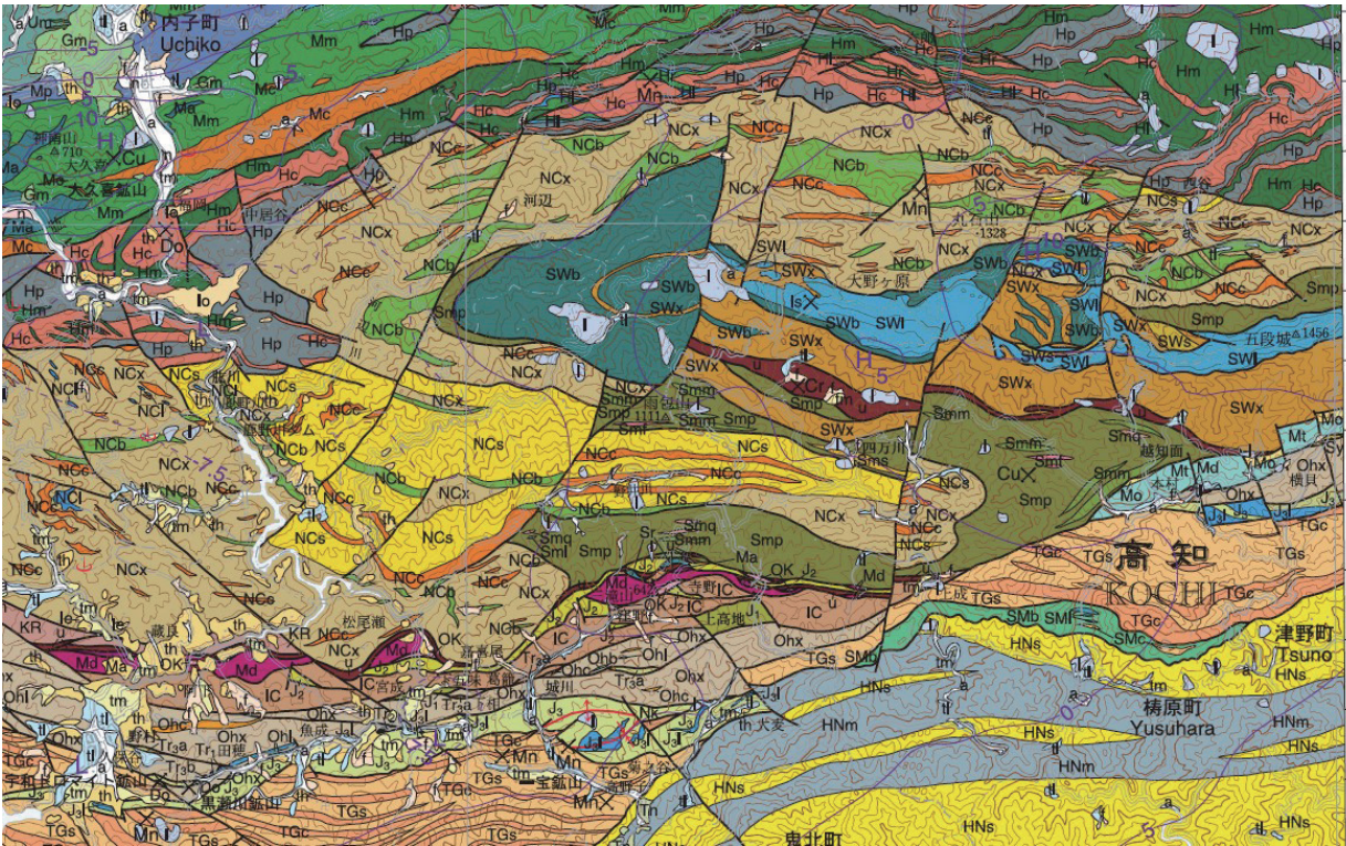
第2図 松山図幅第2版(宮崎ほか, 2016) 図幅南東部(愛媛県と高知県の県境付近)の拡大図 中央部大野ヶ原付近に分布するSWで始まる地層がペルム紀付加コンプレックス, その南に分布するSmで始まる地層が三畳紀高圧型変成岩, さらにその南にレンズ状に分布する岩体Mdはオルドビス紀-シルル紀の深成岩類. uは後期カンブリア紀の超苦鉄質岩.
