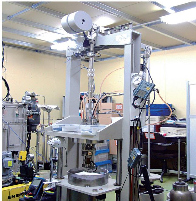
第3図 三軸岩石クリープ実験システム。
