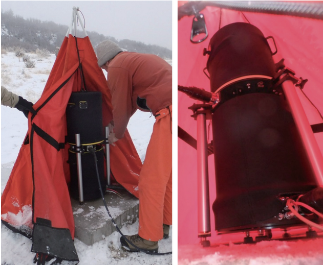
第2図 ユタ州ゴードンクリークでの可搬型絶対重力計 A10 による計測風景。
