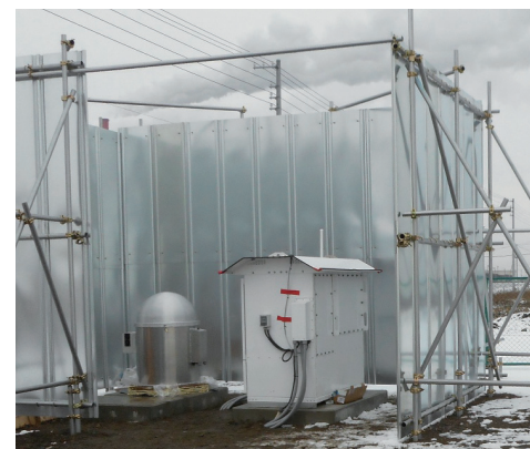
第3図 屋外観測点で簡易収納庫 (エンクロージャ) 内に設置する方式をとった．
