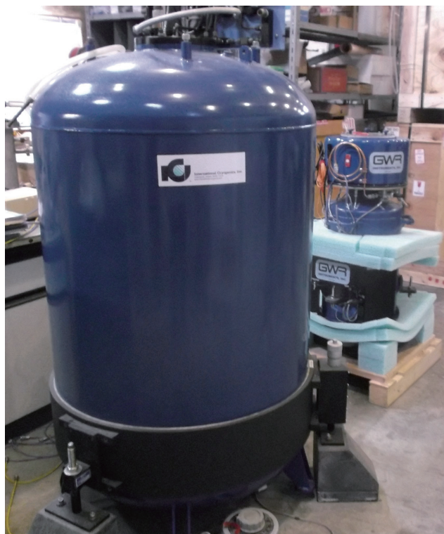
第1図 筑波大学研究基盤総合センター低温部門にあった第一世代超伝導重力計 TT-70 の200リットルのヘリウム容器 (左手前) の横に置かれた第四世代超伝導重力計 iGrav17 本体．iGrav 本体は16リットルのヘリウム容器の上に計測系が載っている．両者ともセンサー部分はヘリウム容器内にある．超伝導コイルの作る極めて安定な磁場で浮上した1インチのニオブ球の位置変化を検出することで重力の変化を測定する装置である．装置のセンサー部は液体ヘリウム温度 (4K) で使用しているため熱的ノイズの影響が無いことで，他の重力計に比べて3桁以上高い1 nGal ( 10^{-11} \text{m/sec}^2 ) の高感度の測定が可能である．
