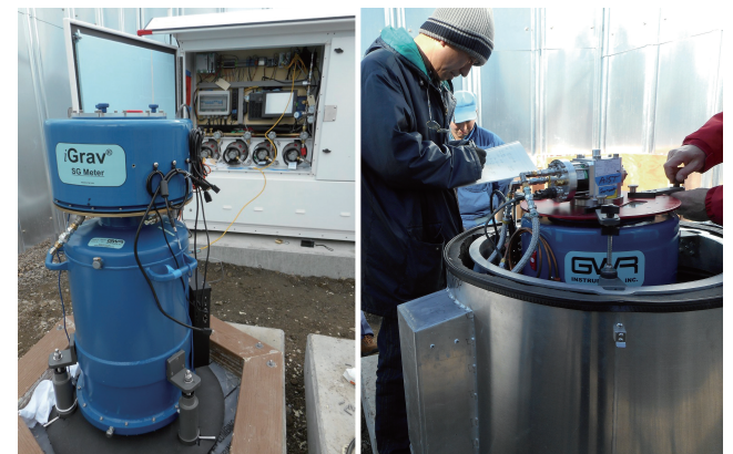
第3図 屋外観測点で簡易収納庫 (エンクロージャ) 内に設置する方式をとった．
