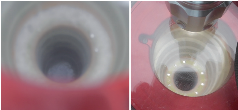
第7図 容器内底部に白い固体空気が存在する(左)とノイズレベルが大きくなる。4K冷凍機を取り出して容器内をヘリウムガスでクリーニングした。クリーニング後に、固体空気が消えて、底部がクリアになった(右)。
