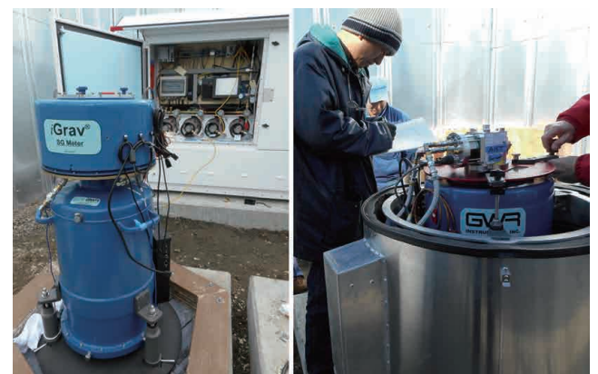
第3図 屋外観測点で簡易収納庫 (エンクロージャ) 内に設置する方式をとった．
