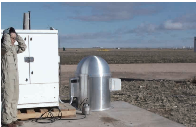
第4図 テキサス州ファンズワースではエンクロージャを活用した屋外観測点での設置。広帯域地震計による並行測定も試みた。設置位置は第1図の1310。
