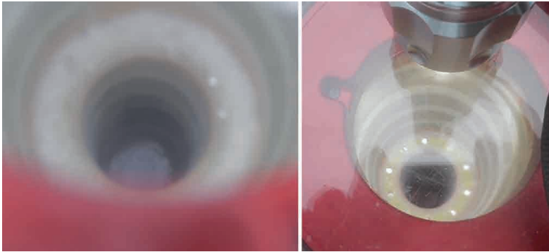
第7図 容器内底部に白い固体空気が存在する (左) とノイズレベルが大きくなる。4K 冷凍機を取り出して容器内をヘリウムガスでクリーニングした。クリーニング後に、固体空気が消えて、底部がクリアになった (右)。
