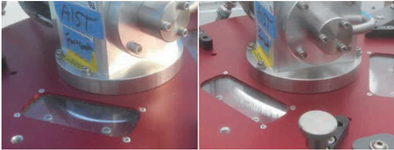
第6図 iGrav 制御系トラブルにより過冷却になり負圧のためにダイヤフラムが見えない状態 (左)。正常時は容器内の内圧によりダイヤフラムが膨らんで見える (右)。
