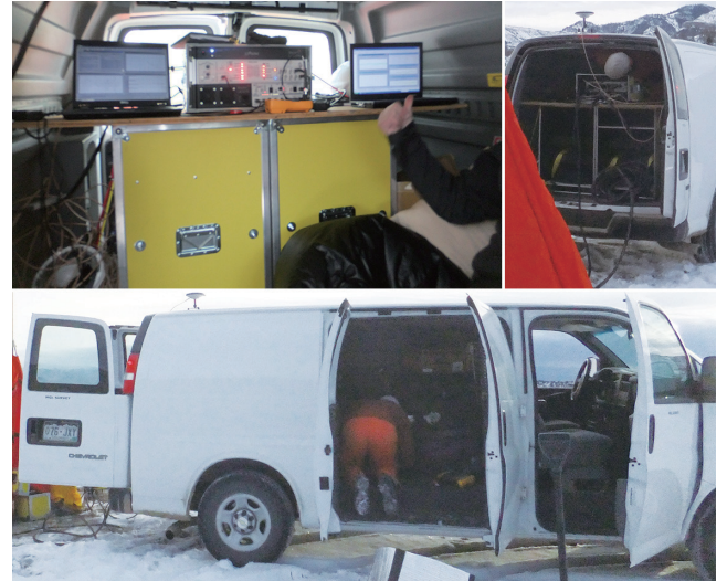
第3図 ユタ州ゴードンクリークでの絶対重力計測時、車両を計測基地として使用。
