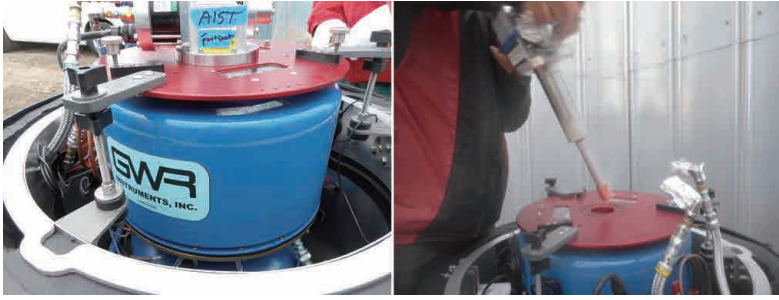
第5図 (左) 4K 冷凍機はエンクロージャの外壁で支えている。iGrav 本体と冷凍機の間には隔膜 (ダイヤフラム) が組み込まれ、冷凍機の振動が超伝導重力センサーに伝わらないように抑制している。(右) 冷凍機を取り出す。
