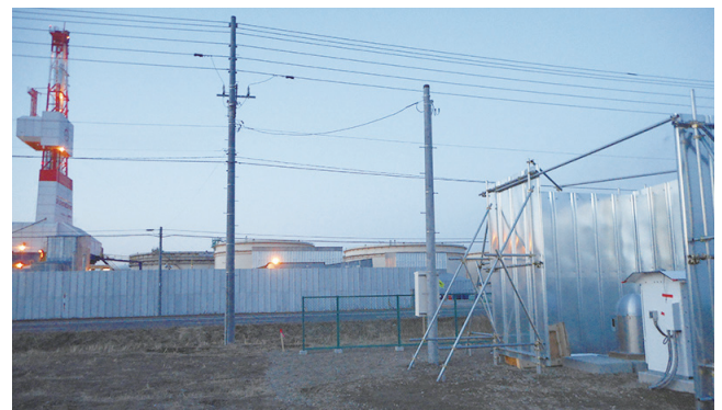
第5図 右の柵内が苫小牧の重力観測点。テキサス州ファンズワースと同じエンクロージャが見える。左後方に見えるのは二酸化炭素圧入井の掘削リグ。
