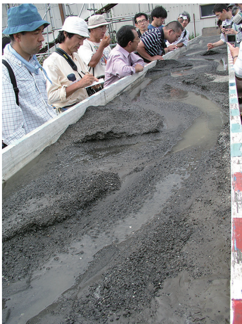
第1図 2004年に筑波大学水理実験センターで開催された大型水路を使った蛇行河川の水理実験会の風景。左手中央でマイクを片手に熱弁をふるわれているのが池田 宏先生。この実験では、礫と砂と水を混合させて水路に流し、現世の蛇行河川の土砂移動を再現している。背後にそびえる建物が、今はなき日本最大級の大型水路施設の建物。
