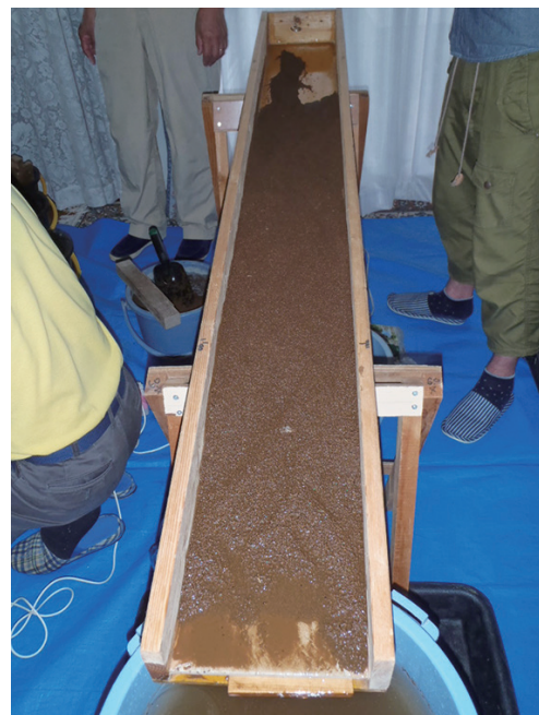
第2図 池田先生が手作りされた3D実験水路および再現された網状河川地形。材料はホームセンターで購入できるものばかりである。給水にはお風呂の排水用の小型水中ポンプを使用し、変圧器を使って流速をコントロールしている。網状河川地形を水路実験で復元することは大変難しく、この実験に用いた土砂は園芸用の鹿沼軽石と記憶している。
