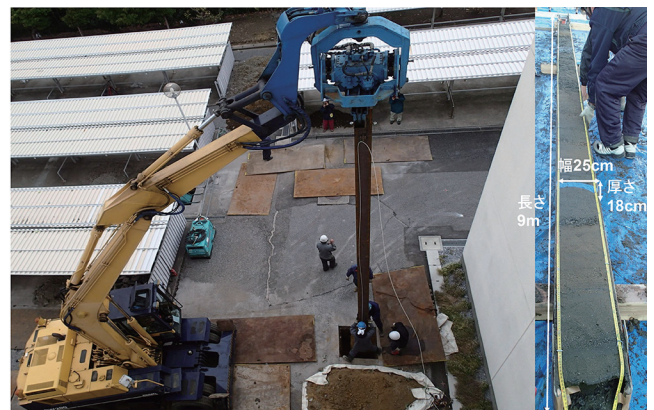
第1図 新 ACE ライナーを用いた千葉県美浜区での液状化 – 流動化調査(左)および採取された試料の一例(右)。
