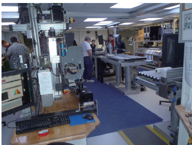
第6図 IODP Exp. 339 のコア記載ラボの風景。テクニシャンが新たに開発した SMISL (Section Half Multi sensor Logger) が設置されている。
