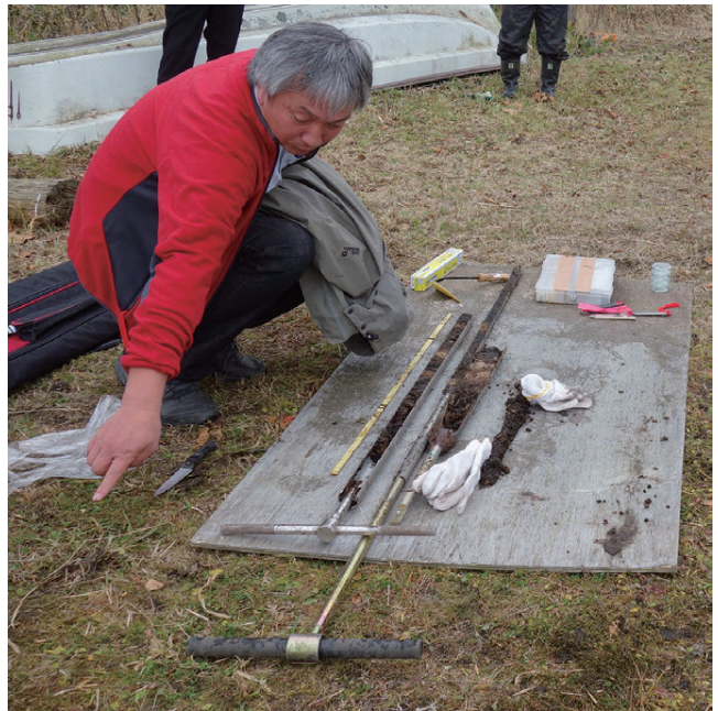
第4図 ボーリング試料の説明。掘削深度毎に複数の掘削試料を並べ、ほぼ同じ層準に同じ時代の火山灰層が出現することを強調した。この際にも、地表面が現在で、掘削深度が深いほど地層の年代は古くなることを繰り返し強調した。
