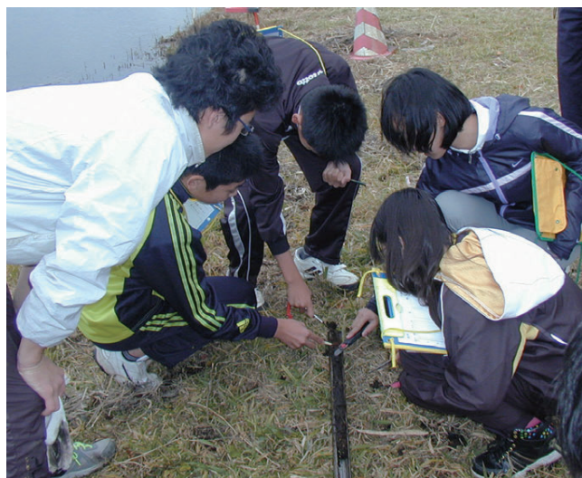
第7図 カッターナイフで柱状試料の表面を熱心に削る児童。泥炭層の中から綺麗な火山灰が出現する度に歓声が上がった。
