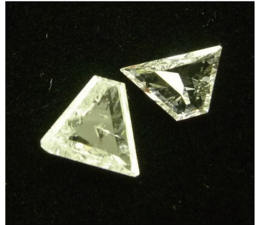
第3図 「マクレ」と呼ばれる, 第2図で三角形に見える面の発達する双晶を利用した, ファンシーカット・ダイヤモンド. 合計 0.48 カラット.
