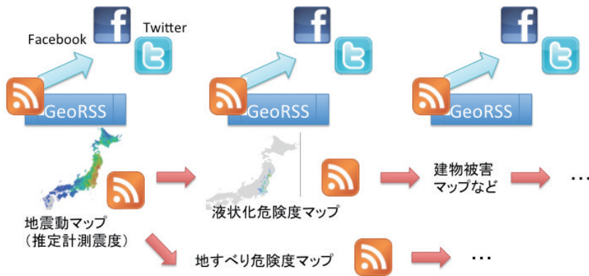
第5図 GeoSNSNotifierによるRSSで連結されたワークフローの例。RSSを用いることでワークフローを自由に構築することができると同時にFacebookやTwitterなどのソーシャルメディアへの通知も可能である。
