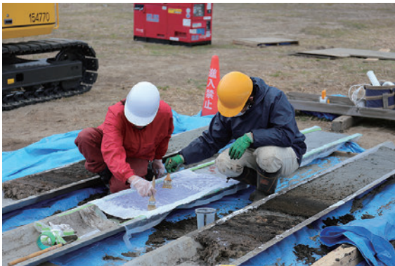
第2図 はぎ取り標本を作製するために接着剤を塗布している様子。
